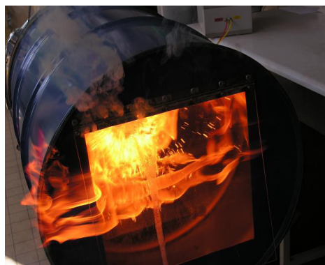
Essai d'inflammation en espace clos
